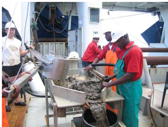
Figure 7a, b et c : montrant l'encavateur de Peterson utilisé pour la collecte des benthos dans les zones des plateformes pétrolières à Cabinda.
