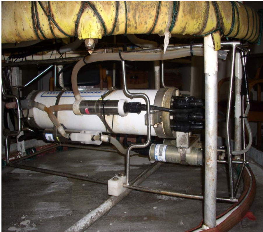
Figure 6 : L'appareil de mesure seabird 911 CTD de prélèvement de température, oxygène, salinité, etc
