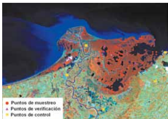
Figura 14. Selección de puntos de campo sobre imagen SPOT 5, sector Tinajones UAC Morrosquillo-río Sinú.
