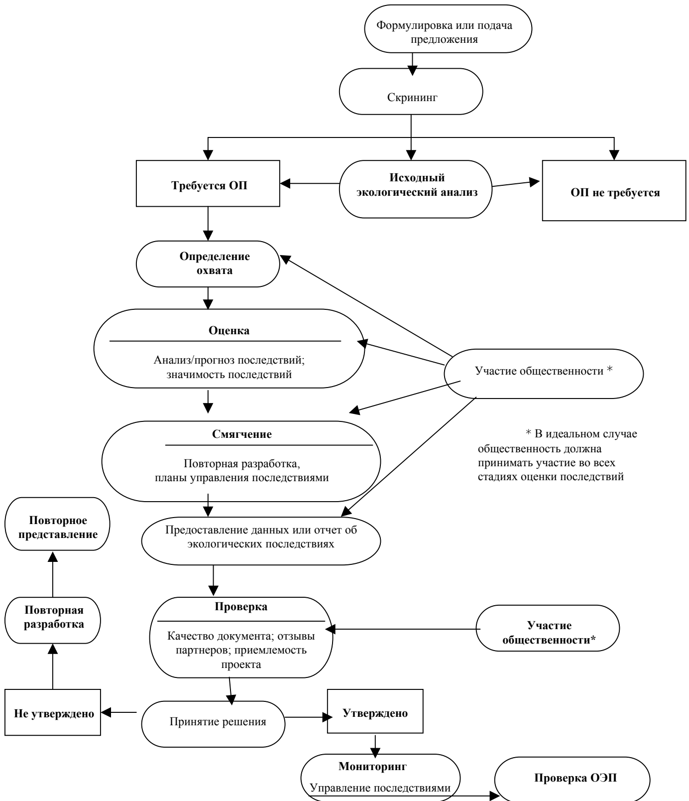
Рисунок 1. Блок-схема основных этапов процедуры ОЭП (Из работы UNEP, 1996, с изменениями, цитируется по работам Anneveldt and Pasman, 2001 и Bagi et al. , 1998)
