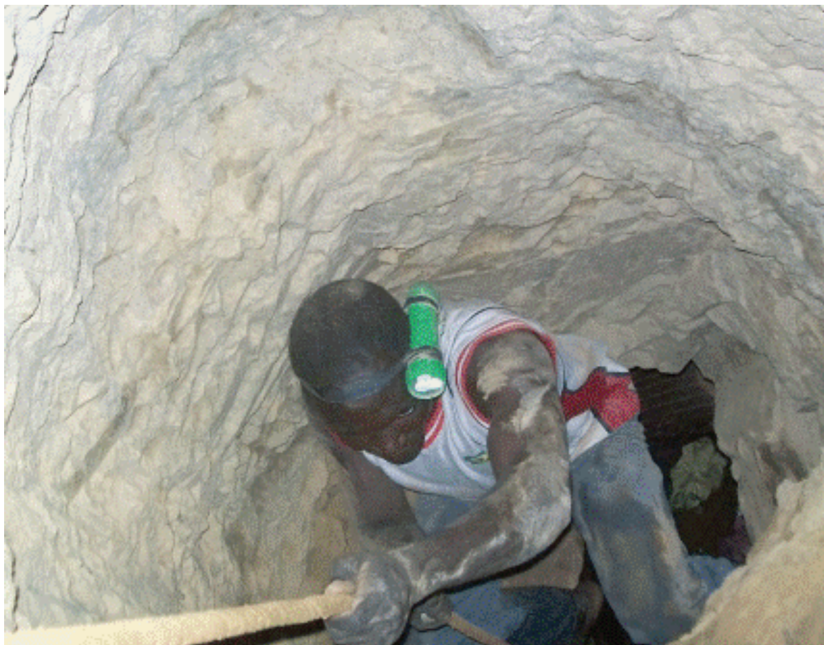
Figure 11: Photo de l'exploitation des gîtes filoniens : la technique des puits verticaux
