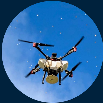
Dron de alta capacidad para la eliminación de roedores. Crédito: Protección de la Isla
