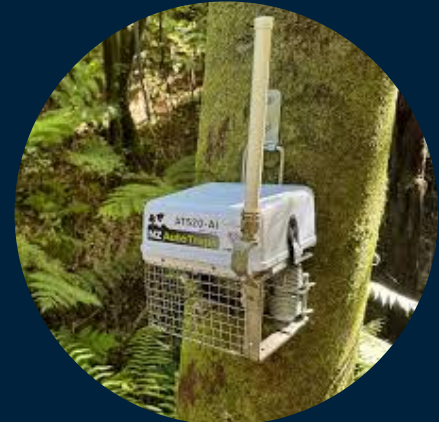
Trampa con reinicio automático que reduce al mínimo los efectos en animales no deseados. Crédito: NZAutoTraps
